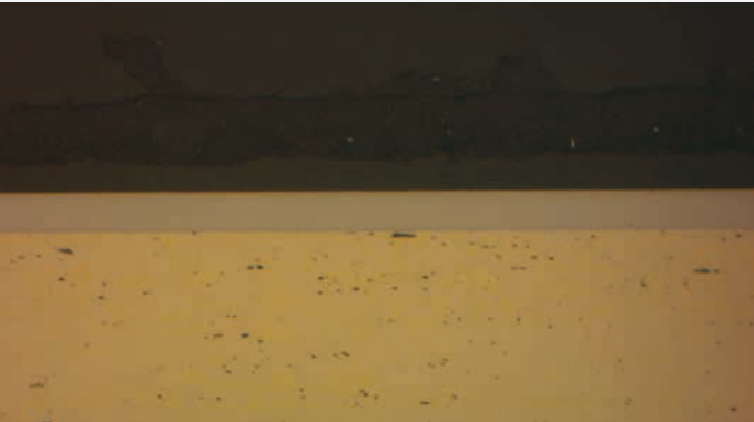
SEM X 200 magnifications - thickness: 29.88 ± 0.83 µm SEM X 200 magnificaciones - espesor: 29.88 ± 0.83 µm
